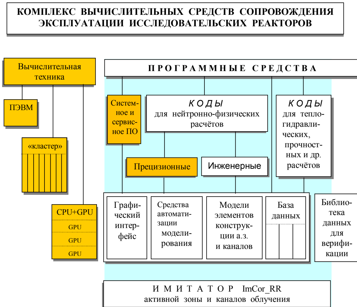
Рис.1. Типовая структура вычислительного комплекса для расчётного сопровождения эксплуатации ИР: ПЭВМ – персональный компьютер с 2-4-х ядерным CPU; «кластер» - система с десятками (сотнями) CPU; CPU+GPU – «гибридная» система (универсальные компоненты отмечены тёмным тонированием)
