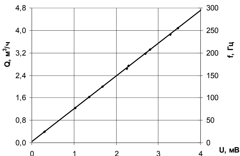
Рис 4. Градуировочная характеристика магнитного расходомера СЭР
