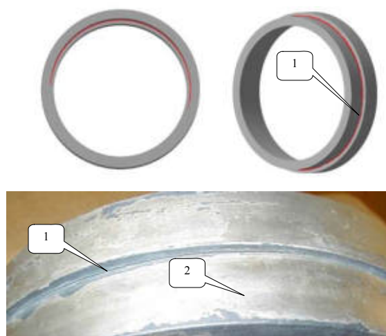
1 – сквозная трещина; 2 - покрытие (Cu-Ni)
