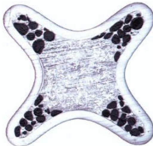
Рисунок 2 – Поперечное сечение твэла с вытеснителем
