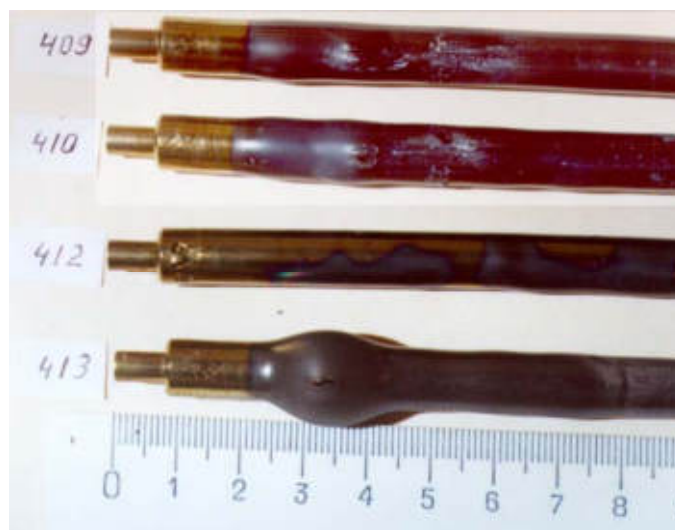
Рисунок 20 - Образцы твэлов ВВЭР после облучения на реакторе БИГР
