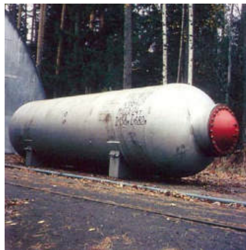
Рисунок 10 Взрывозащитная камера для реактора РИР
