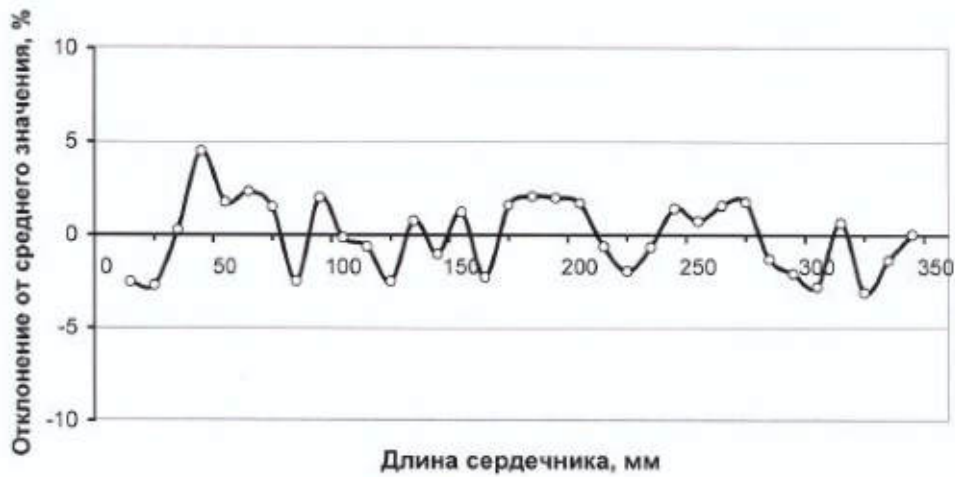
Рисунок 3 – Результаты контроля распределения урана по высоте сердечника
