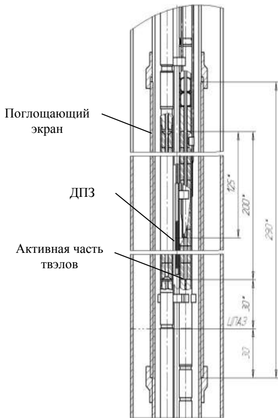
Рисунок 2 - Фрагмент экспериментального устройства . Взаимное расположение твэлов и поглощающего экрана
