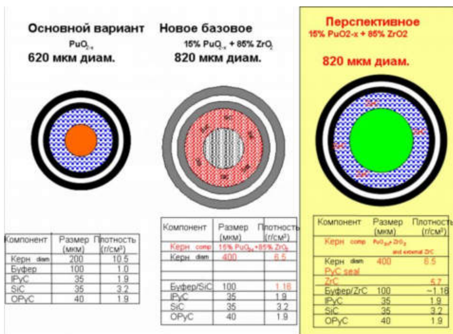
Рис. 3 Топливные частицы основного (базового) и выбранного вариантов топлива
