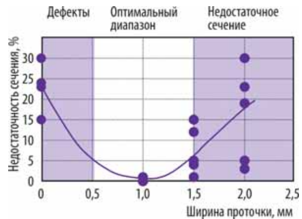
Рис. 4.8. Влияние ширины проточки на проплавление сварного шва
