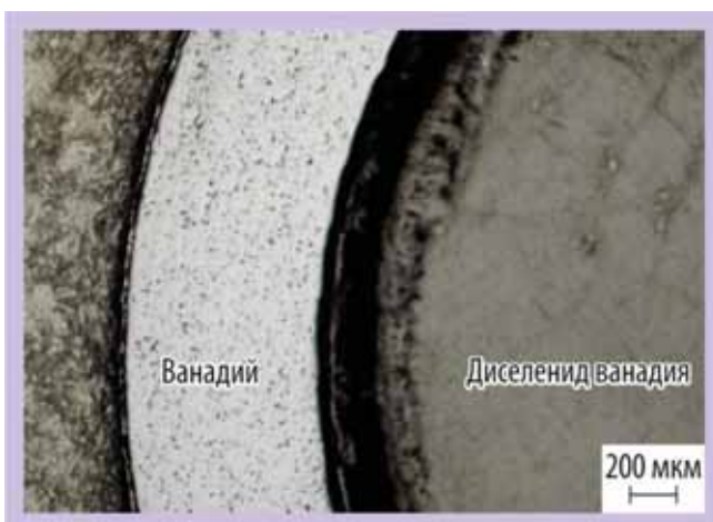
Рис. 4.13. Микроструктура участка поперечного сечения капсулы после термоиспытаний
