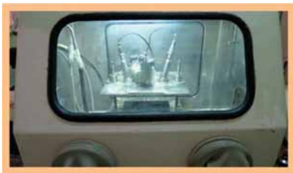
Рис. 3.11. Внешний вид лабораторной установки СВЧ-денитрации, размещённой в радиационно-защитном оборудовании
