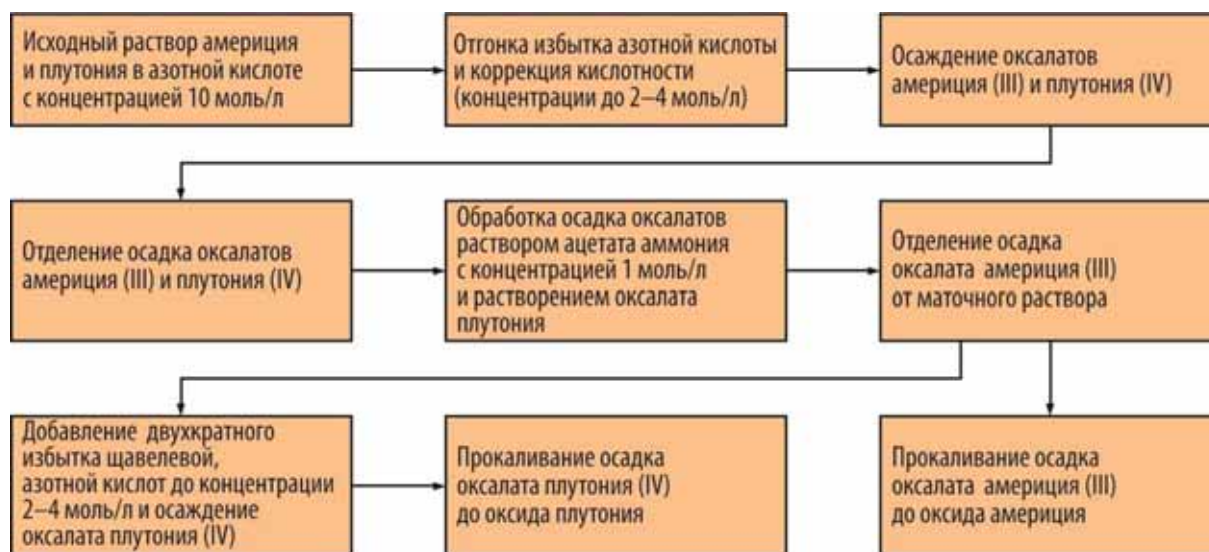
Рис. 3.17. Схема разделения америция и плутония
