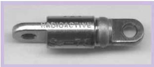
Рис. 4.11. Внешний вид источника гамма-излучения на основе селена-75
