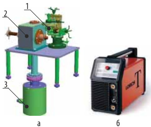
Рис. 4.13. Общий вид установки сварки в радиационно-защитной камере КТУ-03 (а) и источника питания для сварки (б): 1 — сварочная головка, 2 — вращатель, 3 — двигатель
