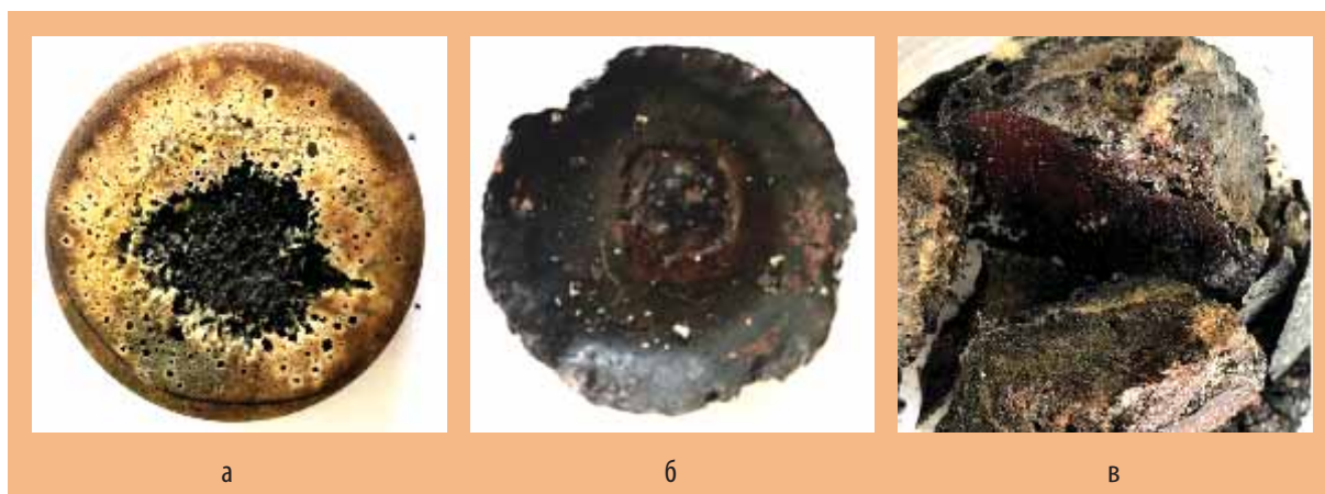
Рис. 3.15. Внешний вид полученных сплавов модельного электролита с гексацианоферратом (III) калия: вид снизу (а), вид сверху (б), вид в расколе (в)
