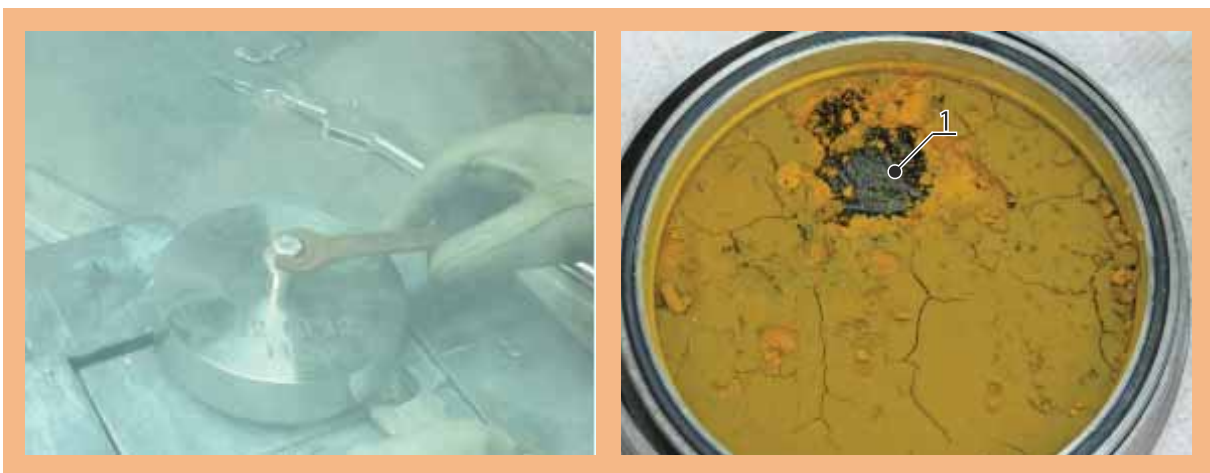
Рис. 3.6. Вскрытие контейнера с фильтром-кейком
