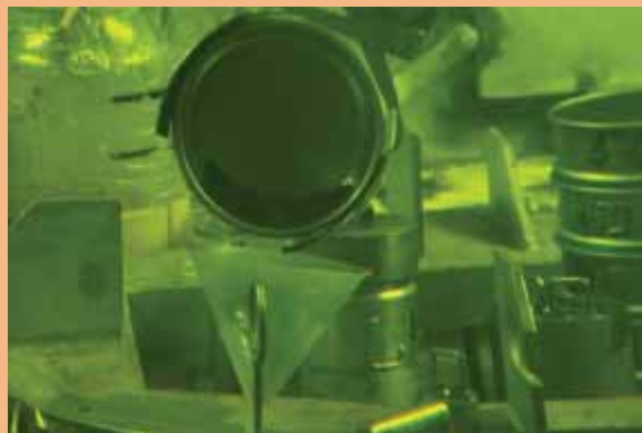
Рис. 3.3. Рассев и фракционирование окисленного топлива в радиационно-защитной камере
