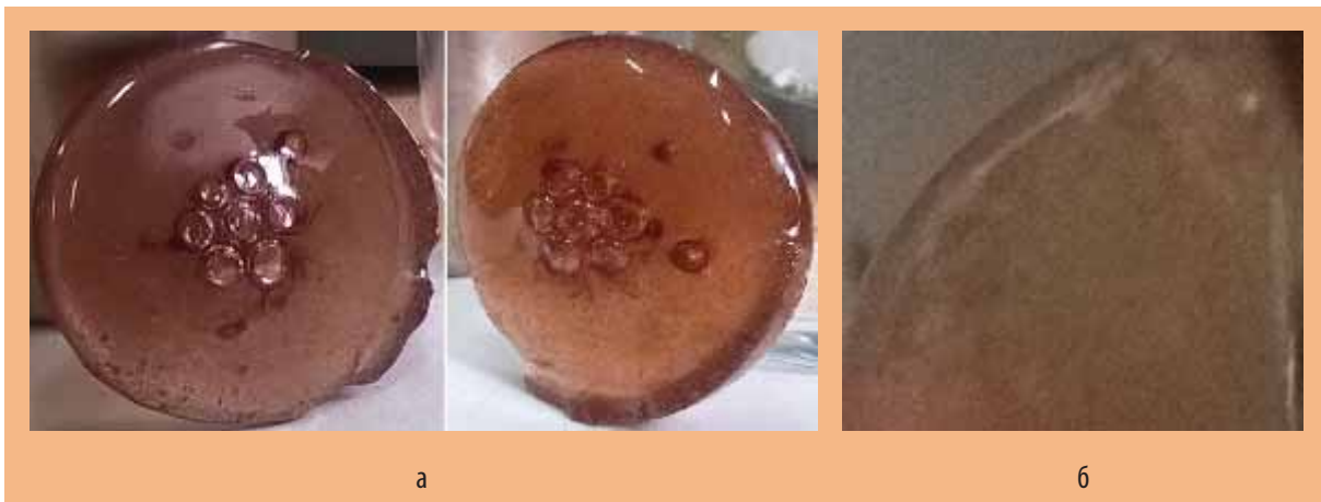
Рис. 3.17. Стеклоподобные образцы М-0 (а) и М-1 (б) молибдофосфатного стекла
