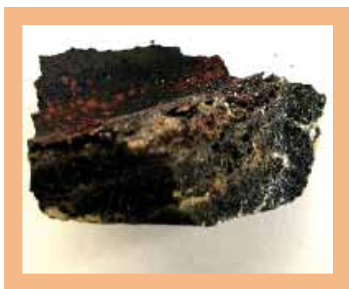
Рис. 3.16. Внешний вид слитка в расколе сплава, полученного при осаждении цезия гексацианоферратом (III) калия
