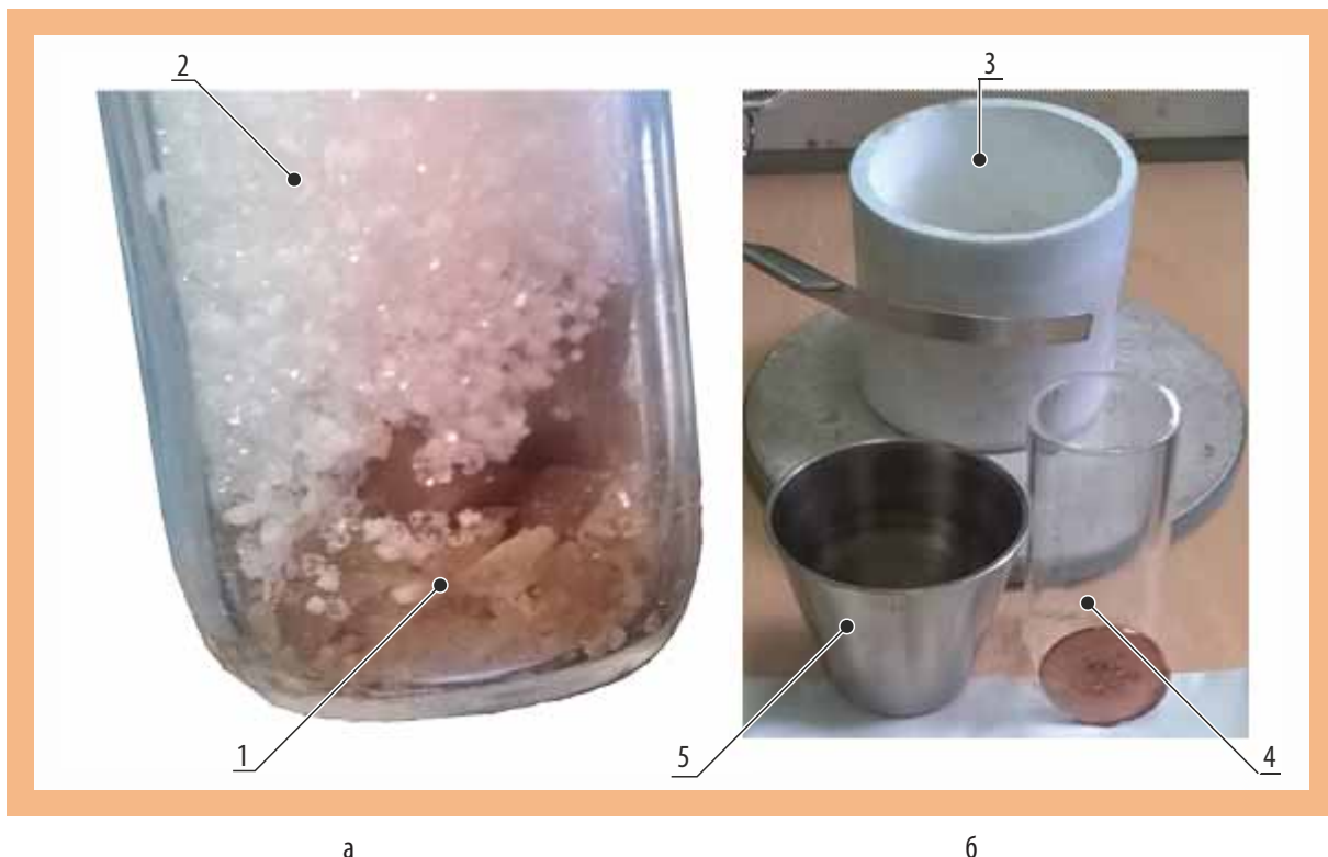
Рис. 3.18. Экспериментальная оснастка: а — кварцевый тигель до варки образца М-0: K_2MO_4-Li_2MO_4-MoO_3 (1) и NaH_2PO_4 \cdot 2H_2O (2); б — керамический тигель (охранный стакан) (3); кварцевый тигель после варки образца М-0 (4); металлический тигель для отжига (5)
