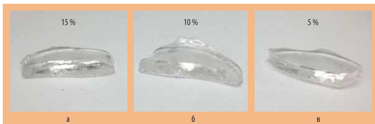
Рис. 3.13. Изготовленные образцы (а, б, в) алюмофторфосфатного стекла с фосфатным продуктом Ca 9 CS 1,34 Na 0,66 (PO 4 ) 6 Cl 2
