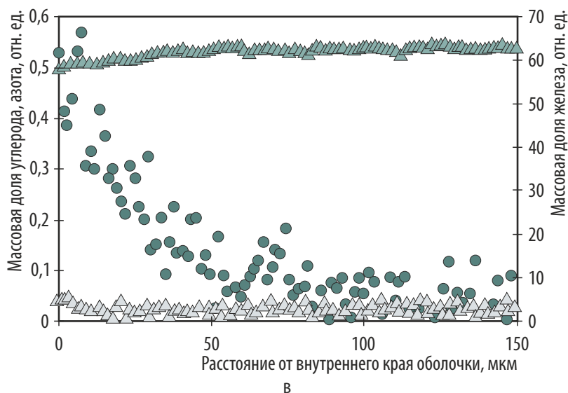
Рис. 2.13. Особенности состояния оболочек твэлов с нитридным топливом вблизи внутренней поверхности: а — повышенная травимось границ зёрен; б — крупные карбидные фазы на границах зёрен: фаза Лавеса; в — науглероживание: \triangle — азот, \bullet — углерод, \blacktriangle — железо
